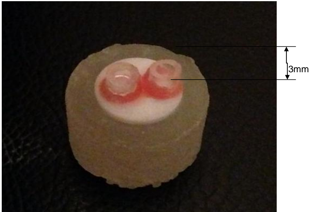
Figura 11 – Posicionamento e altura do tygon tubing no disco de zircônia
