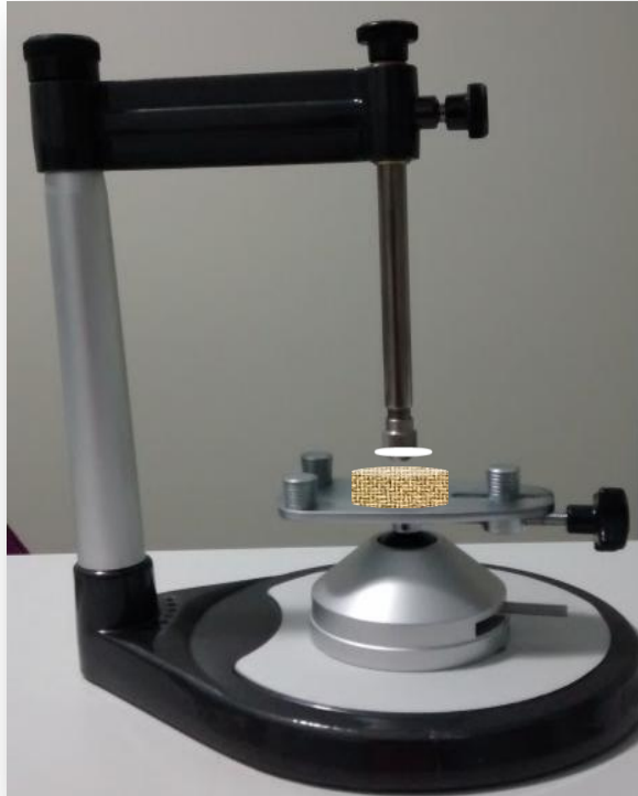
Figura 9: Haste vertical do articulador Bio art B2 com disco jateado fixado com fita dupla- face
