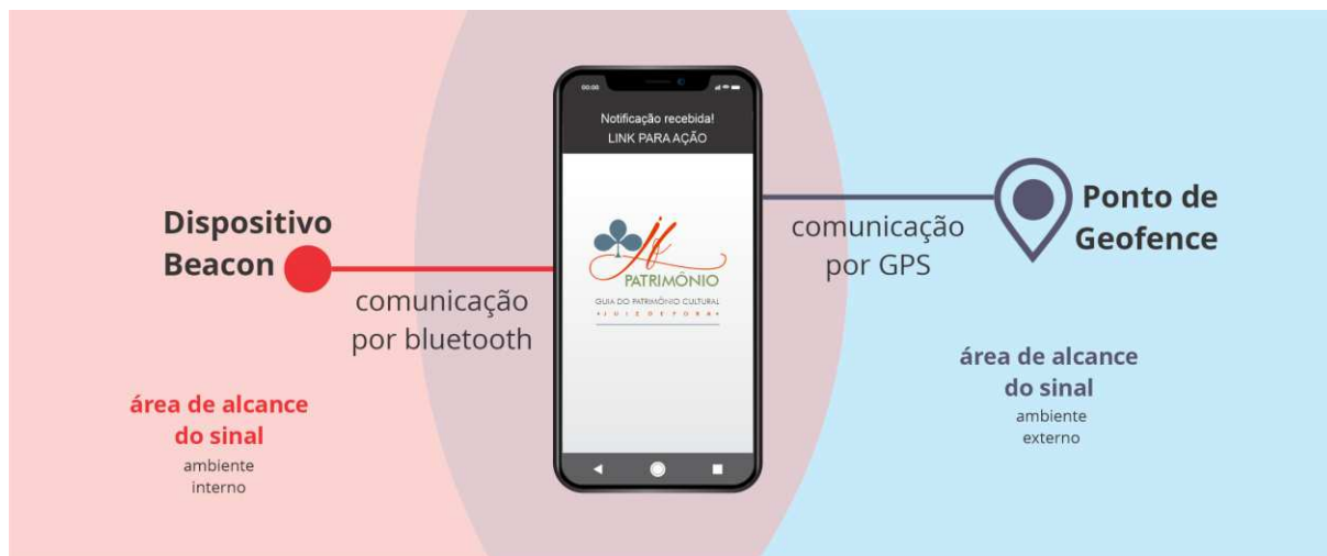
Figura 57 – Esquema da comunicação por beacon e geofence
