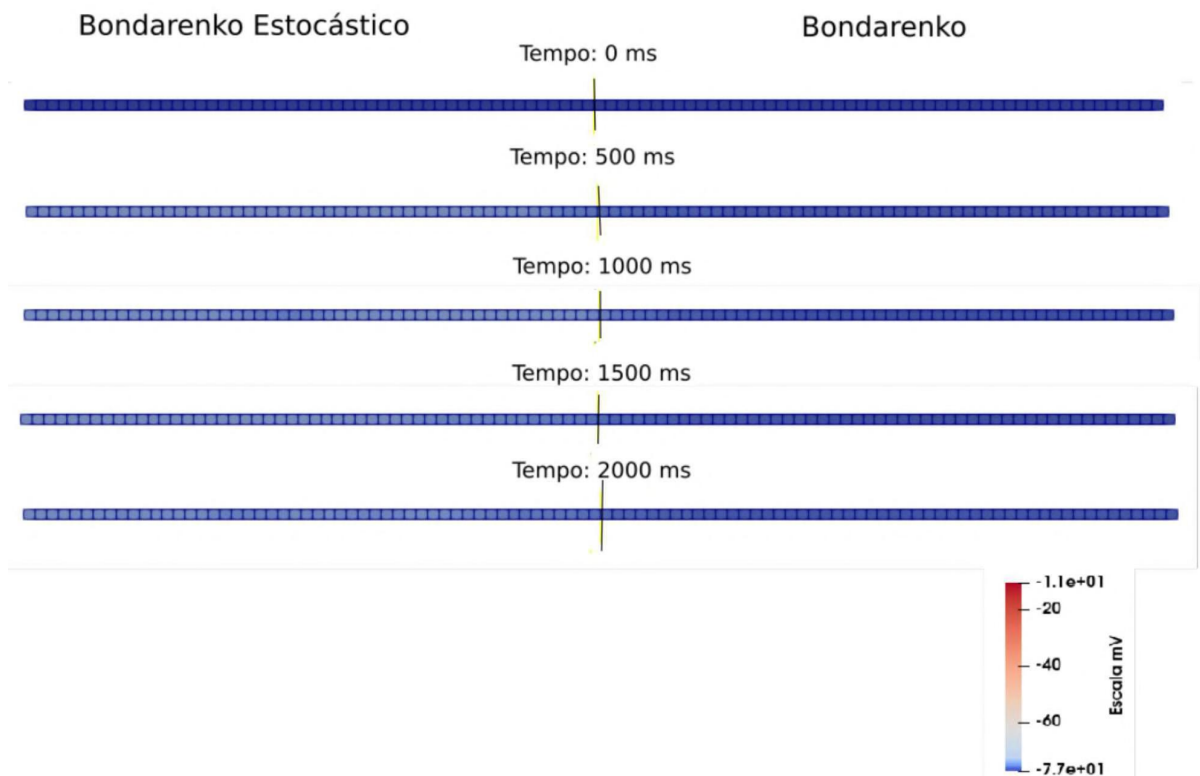
Figura 5.22: Instantes de tempo de um teste realizado com a configuração 4 referente à modelagem estocástica de \frac{1}{2} do cabo do cabo e redução de I_{K1} à metade. O tamanho do cabo para esta simulação foi de 1 cm e o tempo de duração foi 2 segundos. A imagem comprova que não há propagação de PAE nem DAD em quatro instantes de tempo diferentes, t = 0 ms, t = 500 ms, t = 1000 ms t = 1500 ms e t = 2000 ms.
