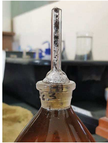
Figura 19: Obstrução na tampa do picnômetro.
