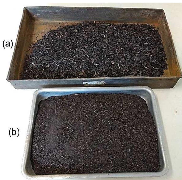
Figura 16: RSU compostado após passagem na peneira nº10 (2.0 mm): fração retida (a) e fração passante (b).
