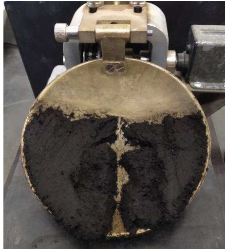
Figura 18: Limite de Liquidez – Aparelho de Casagrande (RSU compostado).
