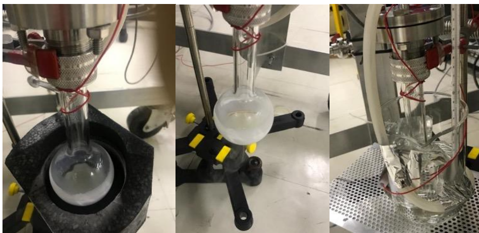
Figura 3.8: Processo de congelamento (figura a direita), bombeamento e liquefação (figura do centro) e amostra pronta para admissão na câmara (figura à esquerda).
