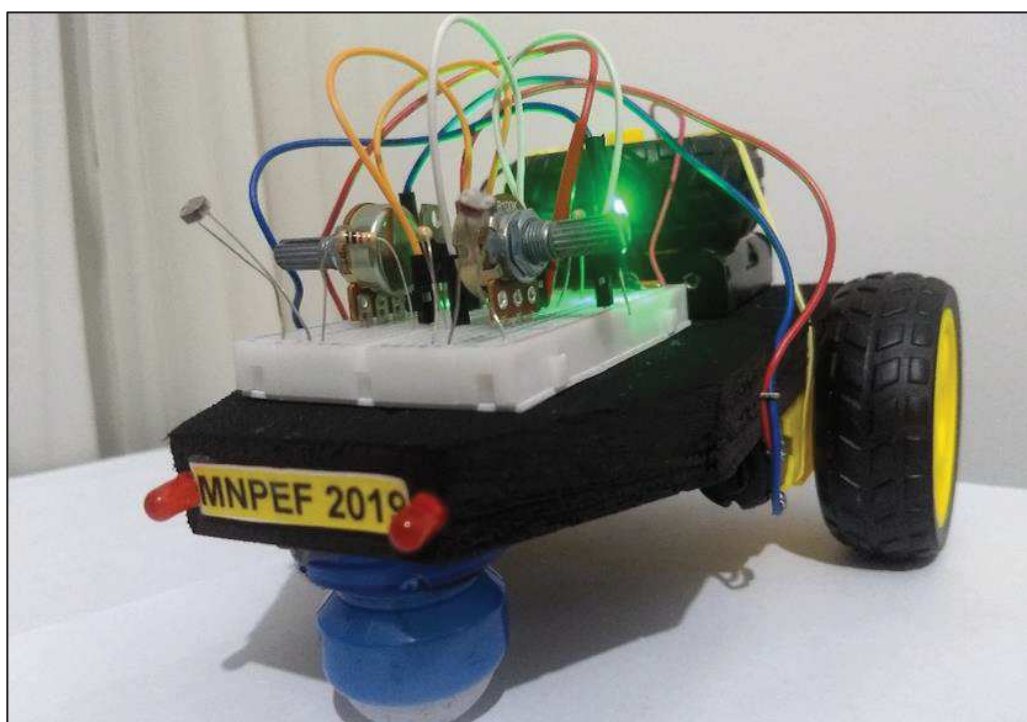
Figura 49 - Carrinho seguidor de luz versão 2020
