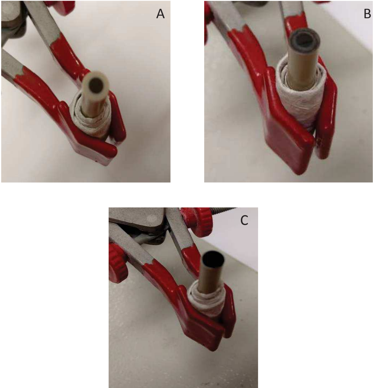
Figura 7. (A) Eletrodo limpo; (B) Eletrodo modificado com OGR; (C) Eletrodo modificado com MWCNT.
