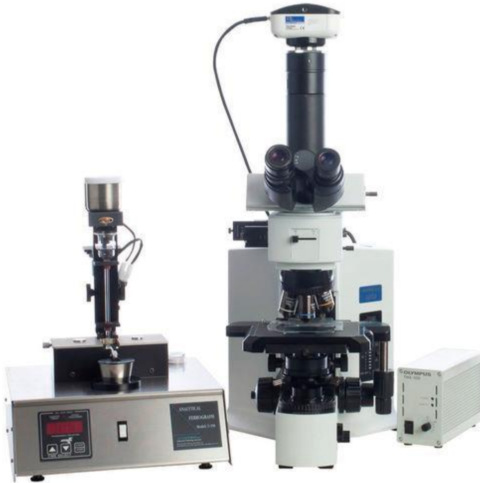
Figura 18 – Ferrógrafo e microscópio respectivamente, utilizados para análise por ferrografia analítica
