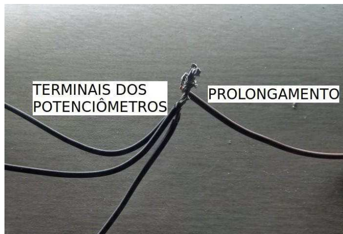
Figura 57 - prolongamento junção do polo negativo
