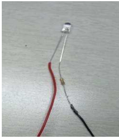
Figura 50 – Ligação de um LED ao resistor
