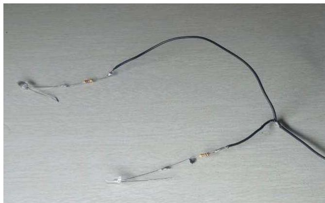
Figura 51 - Ligação do polo negativo de dois conjuntos LED/resistor
