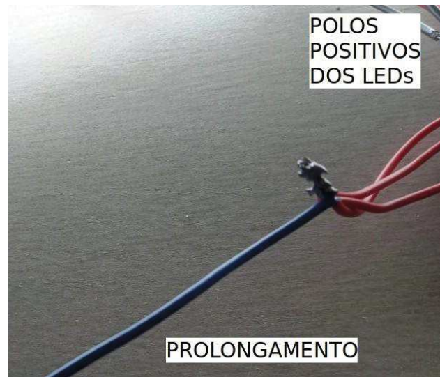
Figura 58 – prolongamento da junção do polo positivo
