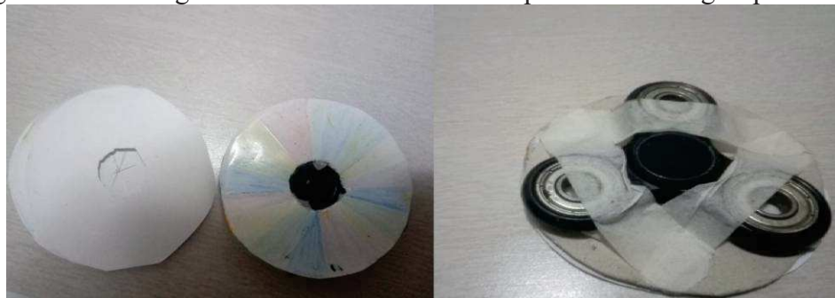
Figura 76 - Montagem de um disco de Newton a partir de um fidget spinner.
