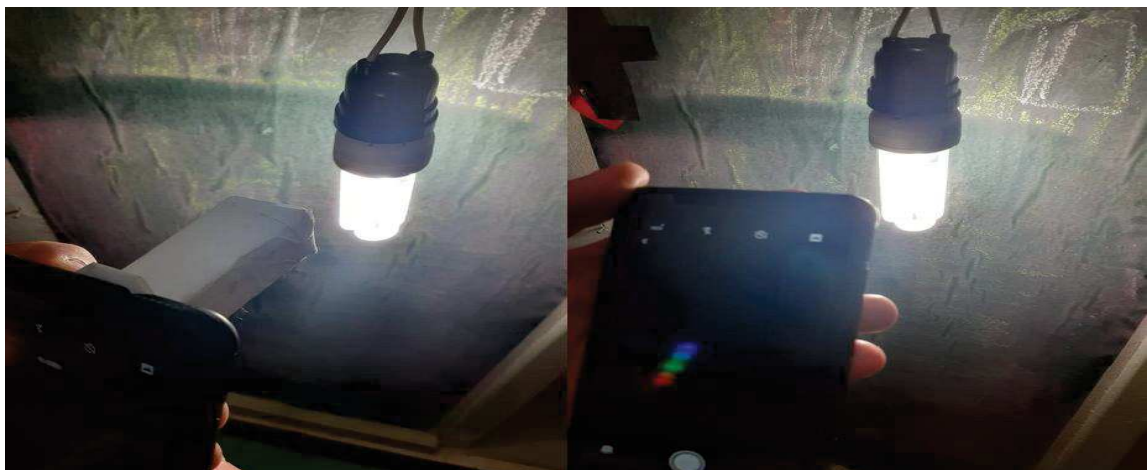
Figura 75 - Registro do espectro de uma lâmpada fluorescente utilizando o espectroscópio caseiro.
