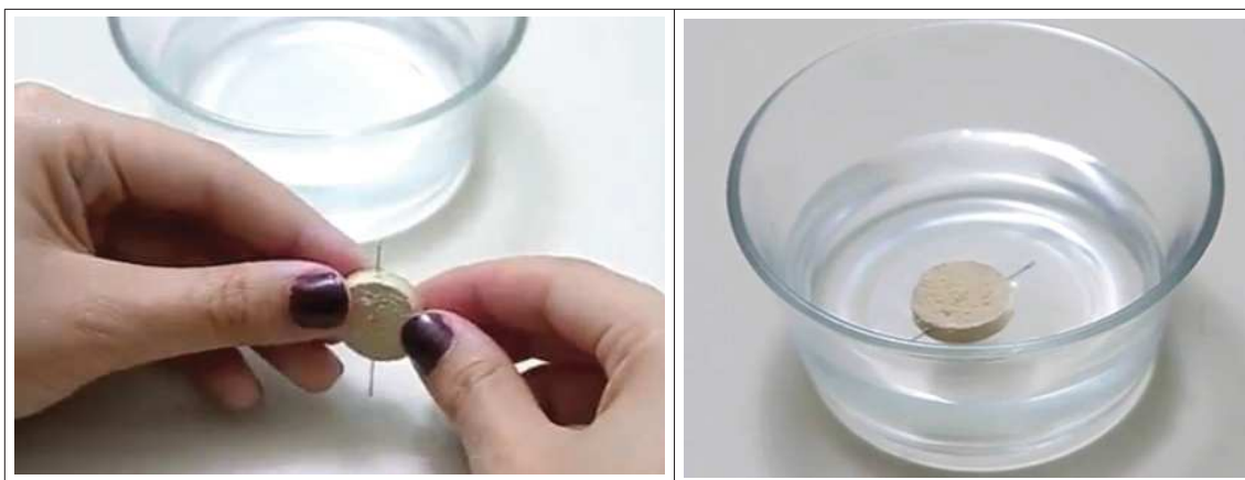
Figura 5 - Construção da bússola
