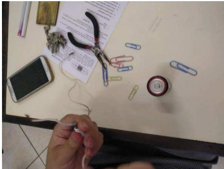
Figura 30. Construindo um eletroímã.
