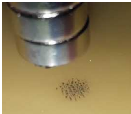
Figura 18. Identificando ferro no meio do cereal com ímãs de neodímio.
