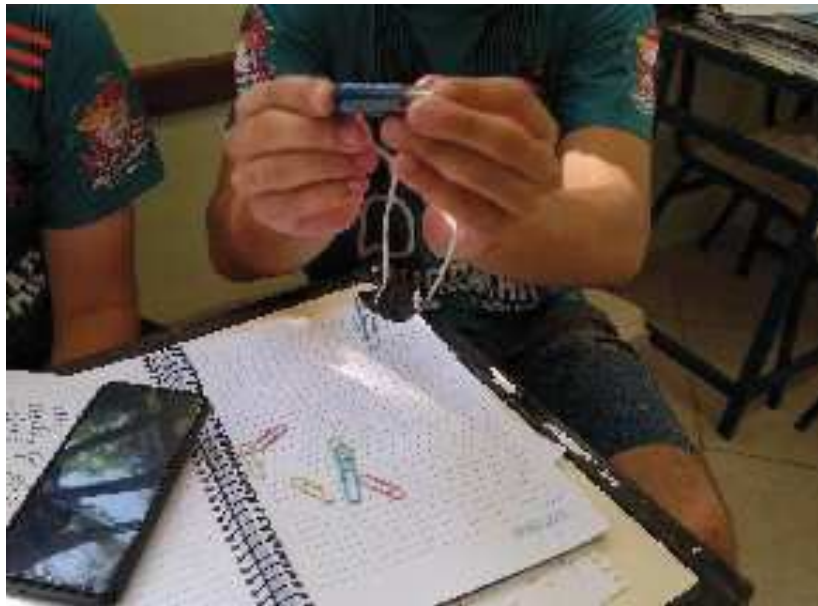
Figura 34. Construindo um eletroímã.
