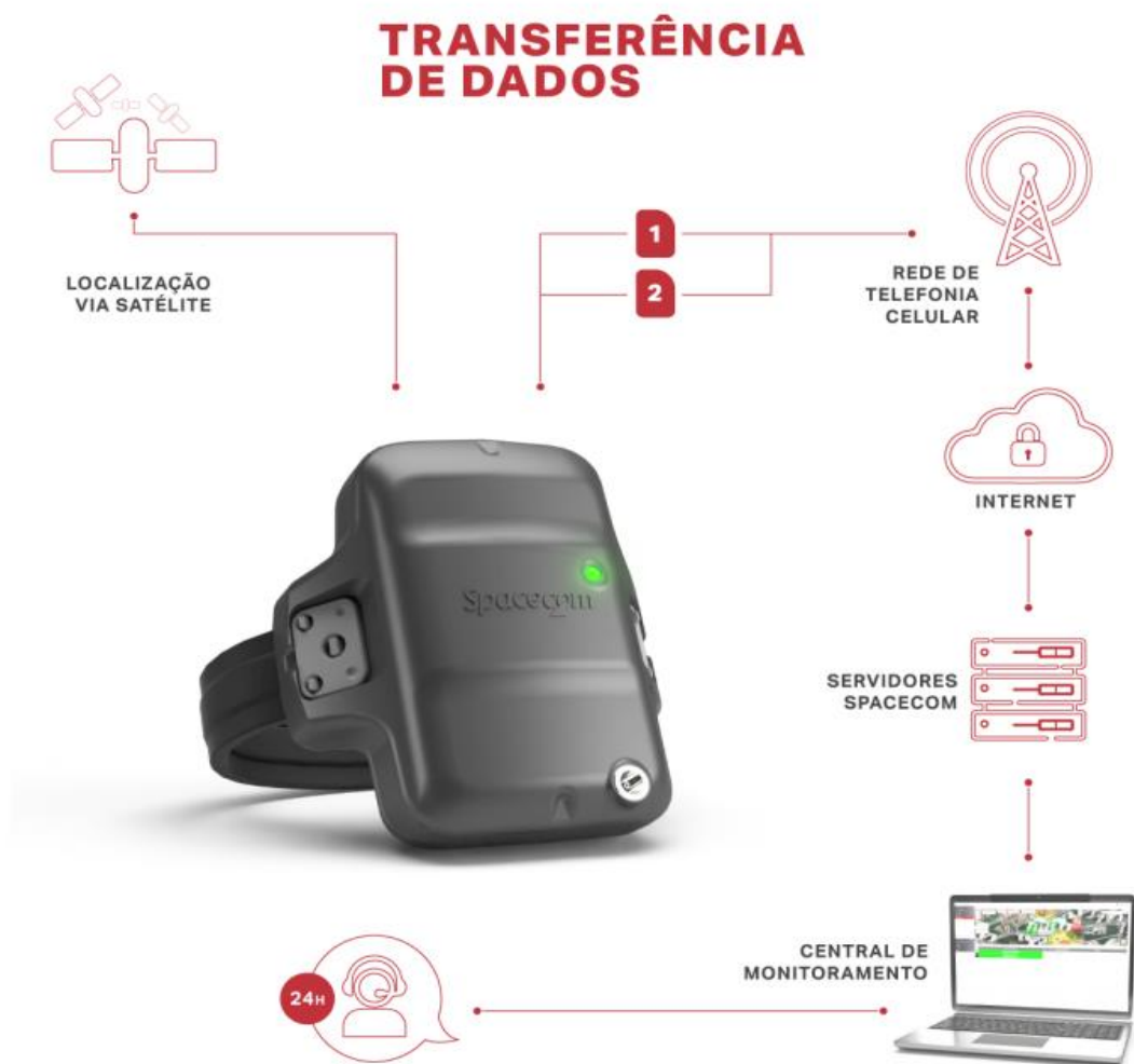
Transferência de dados entre a tornozeleira e a central de monitoramento. Fonte Spacecom.
