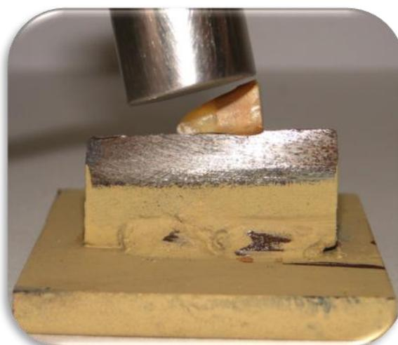
Figura 5: Base com plano inclinado para clivar o dente.
