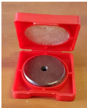
Figura 31 – Bloco padrão de calibração para dureza Rockwell C
