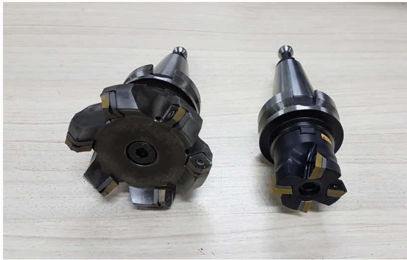
Figura 23 – Fresas de topo planetárias utilizada na usinagem
