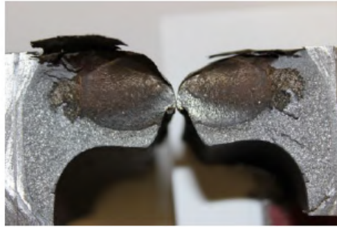
Figura 16 – Fratura em trilho devido a ocorrência de Rechupe
