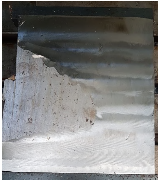
Figura 24 – Face da Amostra sendo desbastada na Romi D600
