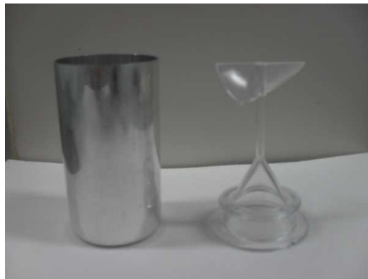
Figura 15. Porta-amostra e agitador para análise em RVA
