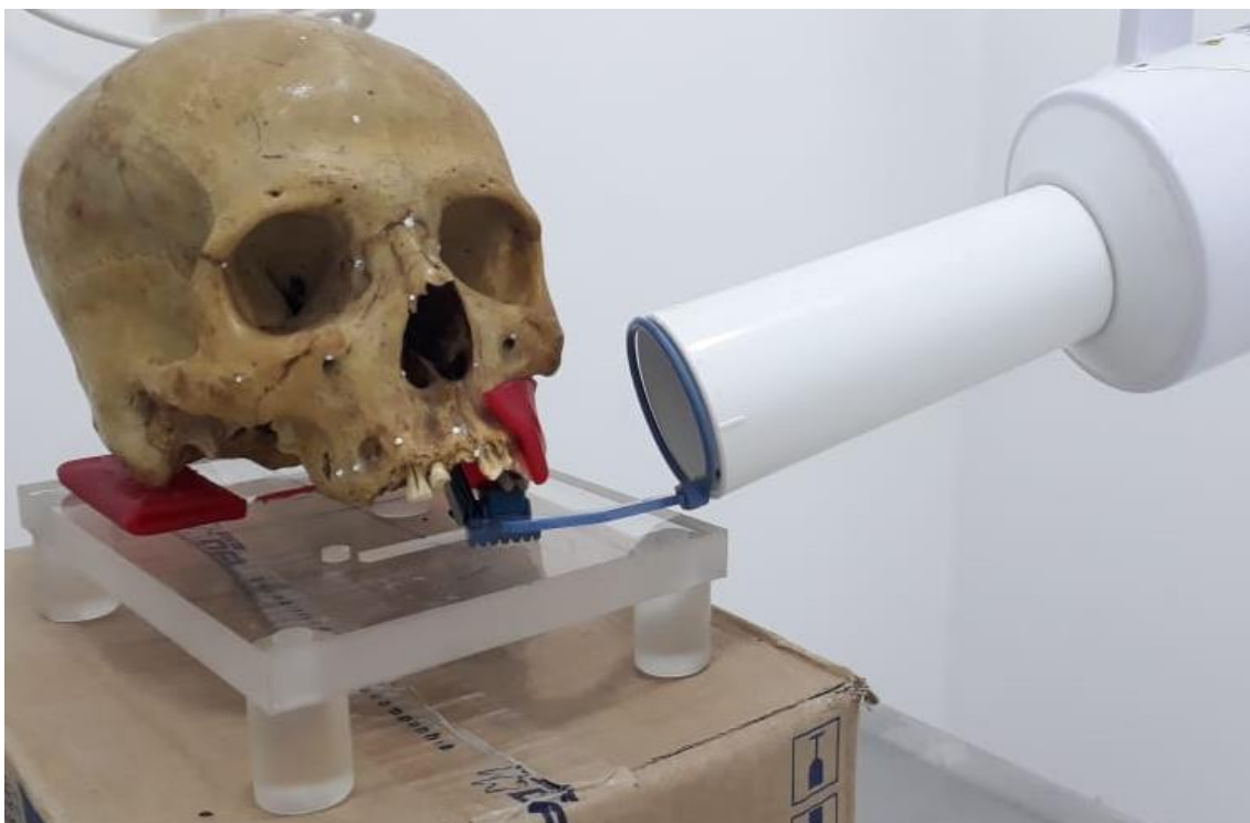
Figura 1 – Dente posicionado em uma maxila humana seca em um dispositivo de acrílico para realização das radiografias periapicais.
