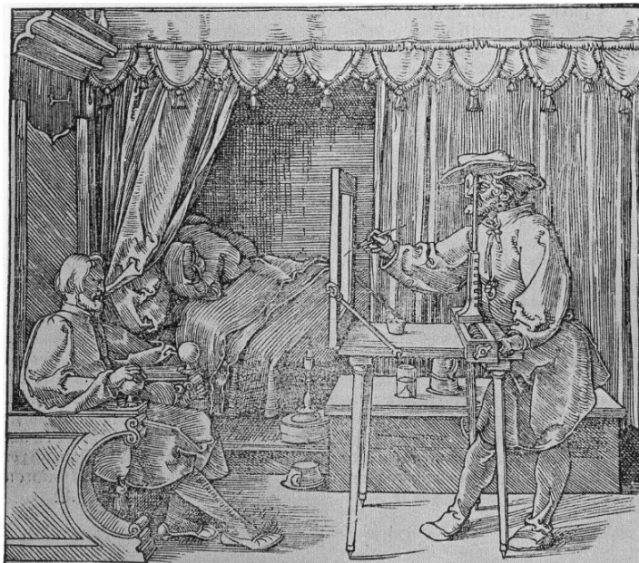
Figura 28: Perspectógrafo construído utilizando-se um painel de vidro enquadrado e moldurado num quadro de madeira.
