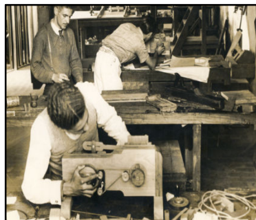
Figura 40: Produção da Máquina de Lissajous nas Oficinas da EEJF Fonte: Acervo MDCT da UFJF
