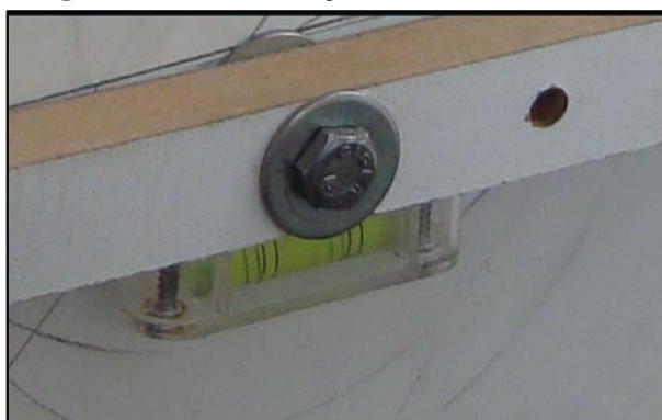
Figura 6 – Visualização do nível sob a haste
