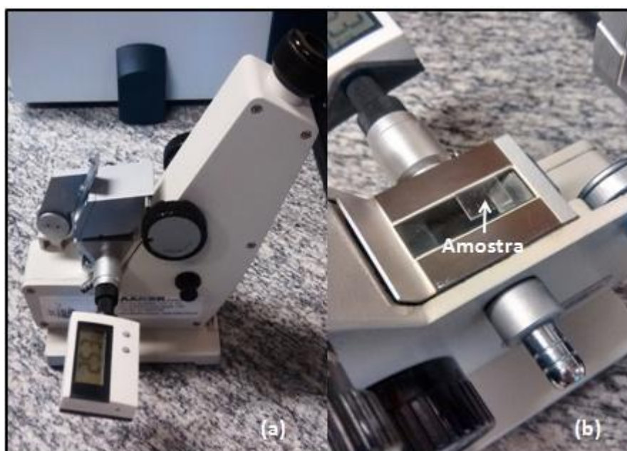
Figura 4.6 - Refratômetro utilizado para a determinação do Índice de Refração Linear (IRL) das amostras: (a) parte exterior e (b) parte interior onde a amostra é acoplada ao prisma refrator. [FARACO, 2015]
