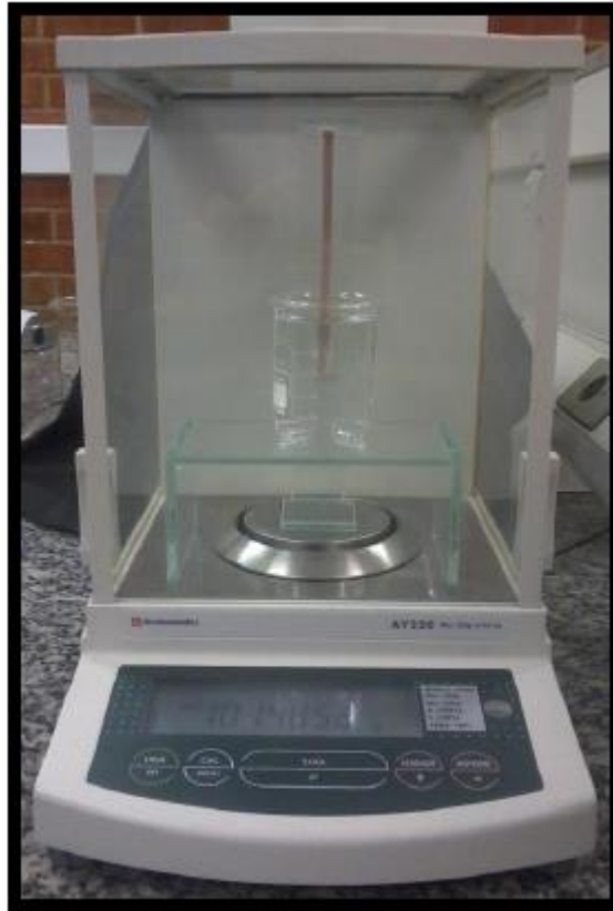
Figura 4.2 Aparato experimental utilizado para a determinação da densidade. [SOUZA, 2013 and OLIVEIRA, 2013]
