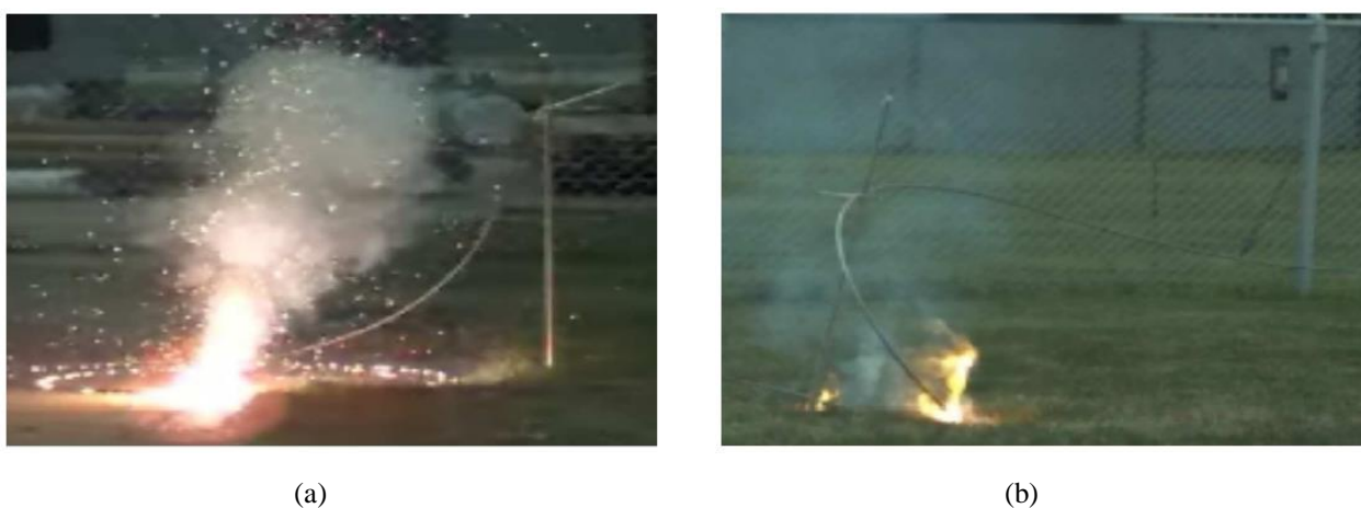
Figura 86. Exemplos de HIF. (a) HIF em concreto (GHADERI et al., 2015) e (b) HIF em grama (GHADERI et al., 2017)
