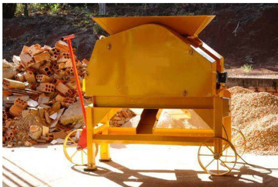
Figura 7 - Máquina de reciclar resíduos da construção civil.
