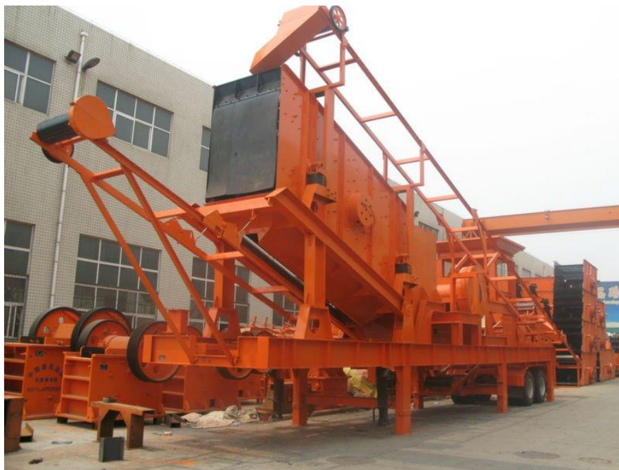
Figura 8 - Estação móvel de britagem de resíduos da construção civil.
