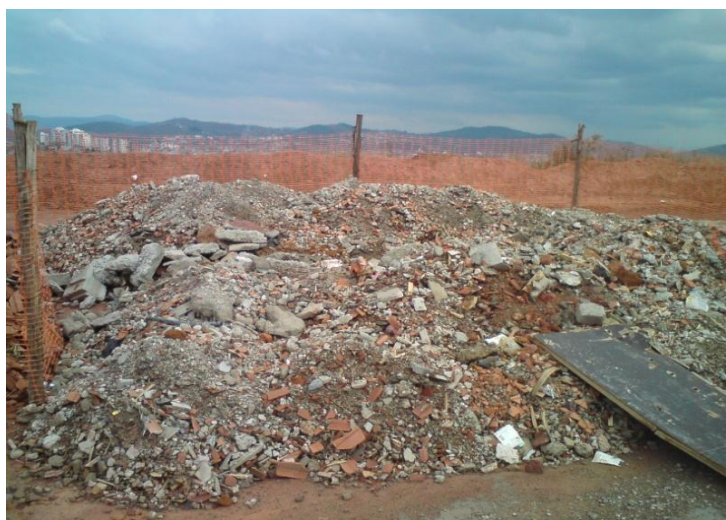
Figura 31 - Baía contendo entulho (resíduos de concreto, argamassa e tijolo).
