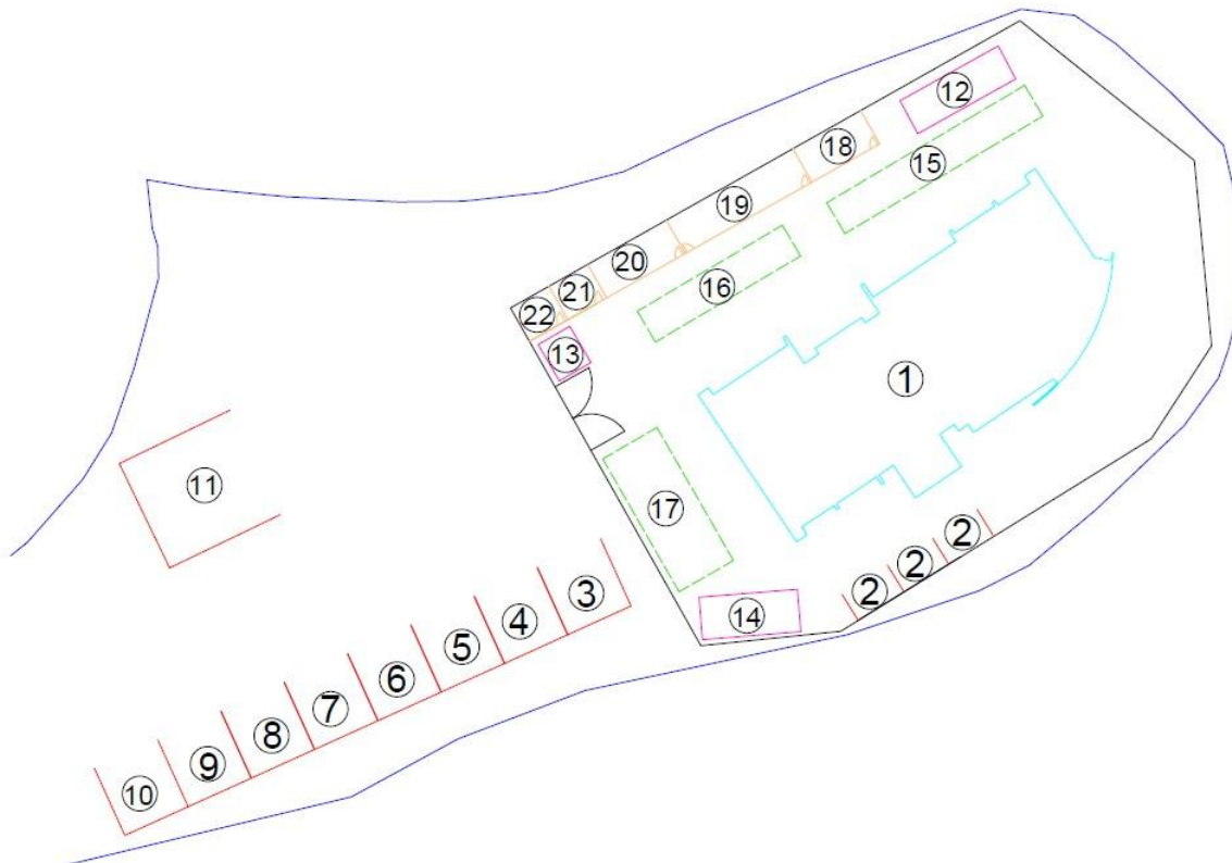
Figura 13 - Arranjo físico do canteiro de obra.
