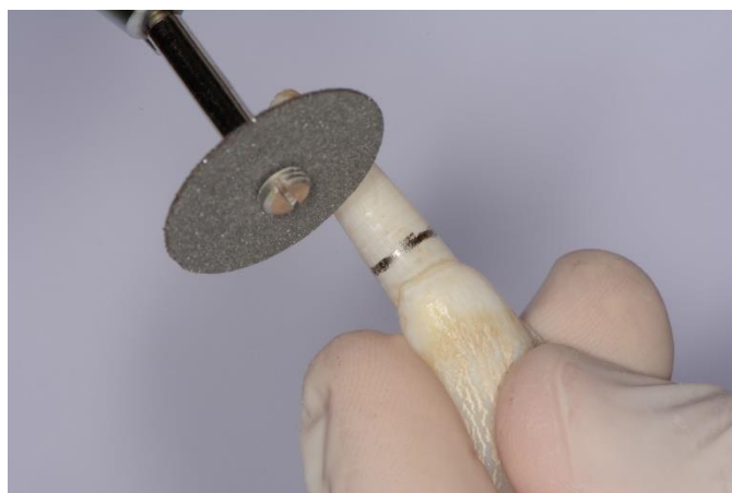
Figura 2- Corte da raiz em 18mm de comprimento, com disco de carborundum sob refrigeração.
