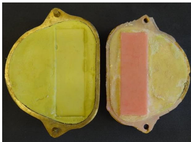
Figura 5 - Corpos de prova de resina acrílica termopolimerizável após polimerização. (Badaró, 2013)
