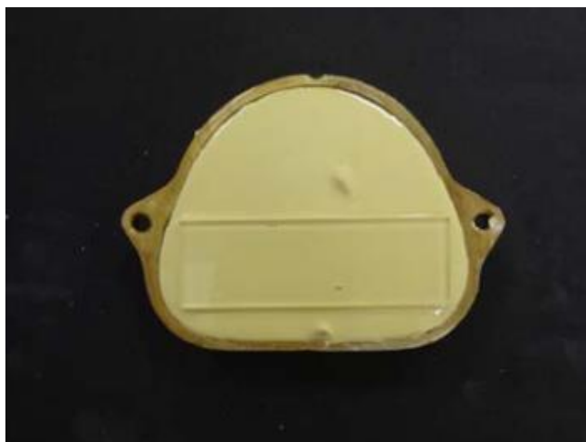
Figura 2 - Inclusão em mufla da matriz de plex glass para confecção dos moldes. (Badaró, 2013)
