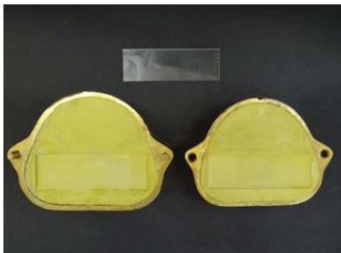
Figura 3 - Molde obtido em gesso especial tipo IV (Badaró, 2013)
