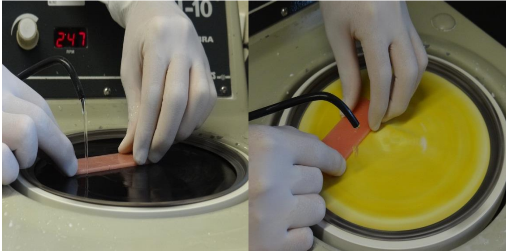
Figuras 7 e 8 - Polimento dos corpos de prova com lixas de granulação diversas e disco de feltro (Badaró, 2013).
