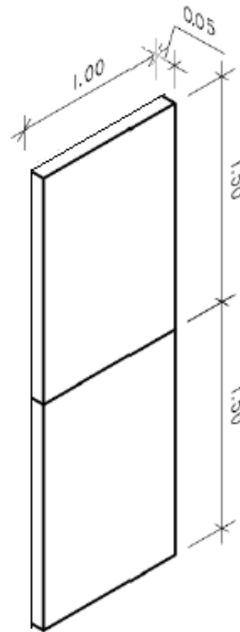
Figura 3.9: Esquema da parede de concreto projetado em um comprimento de 1 m e altura de 3 m.
