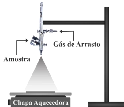
Figura 23: Esquema do sistema de deposição por sprayer usado para a produção dos filmes finos. Figura retirada de Lima et al. 106
