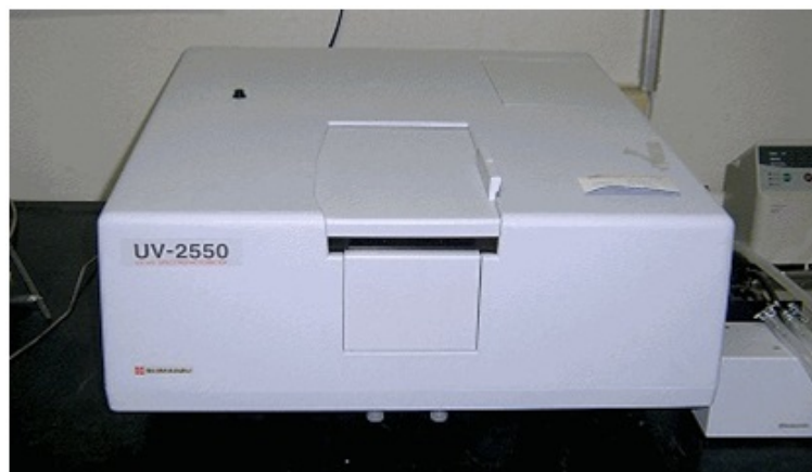
Figura 29 – Espectrofotômetro UV-Vis Shimadzu de duplo feixe modelo UV 2550 que opera na faixa de 190nm a 1100nm.
