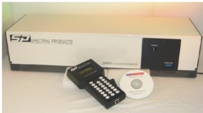
Figura 19 – Monocromador do tipo Czerny-Turner modelo DK480 da Spectra Physics com seu controle externo e o cd de instalação do programa.
