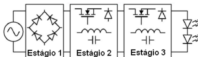
Figura 2.8: Representação dos estágios de um driver.
