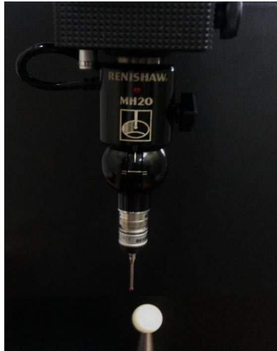
Figura 16: Manípulo com sistema de força constante, apalpador eletrônico e ponta calibradora de zircônia
