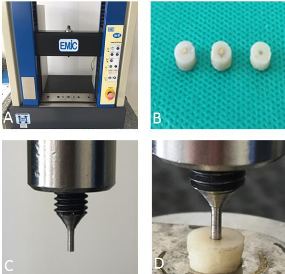
Figura 6: Máquina universal de ensaios (A); Corpos de prova finalizados (B); Ponta de 1,2mm de diâmetro posicionada na parte superior da máquina universal de ensaios (C); Corpos de prova posicionados para o teste mecânico “push-out” (D).
