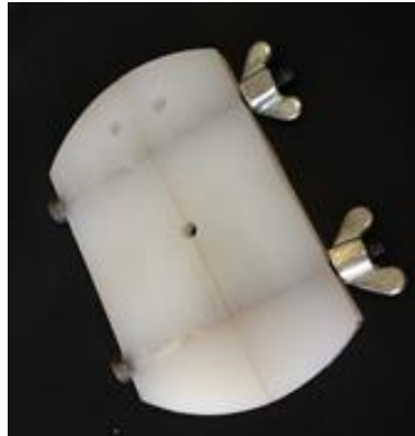
Figura 2 - Matriz de náilon para confecção de corpo de prova para o ensaio de resistência à compressão
