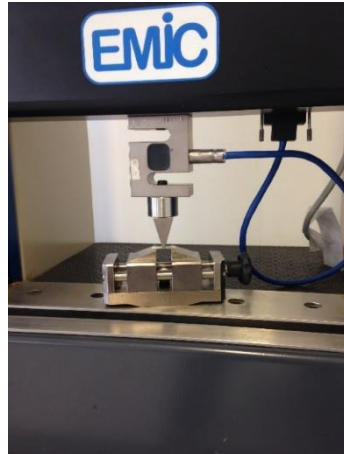
Figura 6 - Teste de resistência à flexão sendo realizado na EMIC
