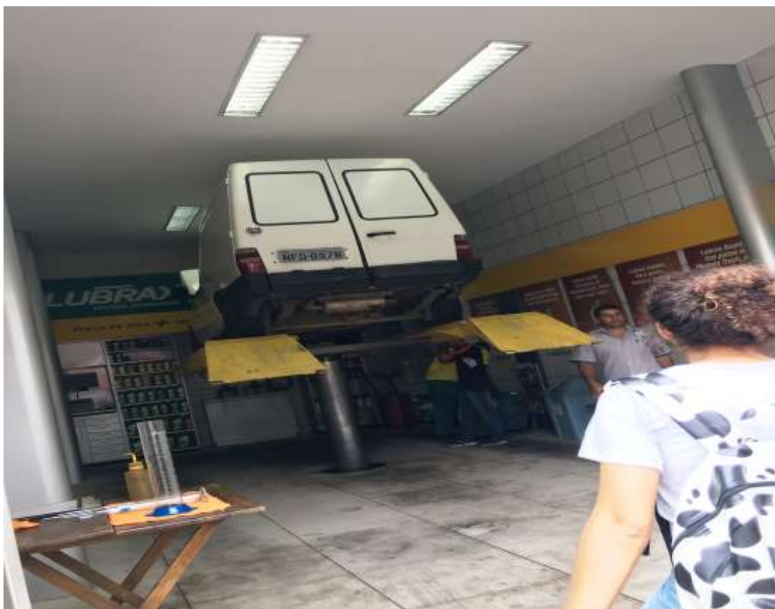
Figura 17 – Alunos acompanham funcionamento do elevador hidráulico.
