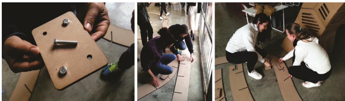
Figura 67. Gabarito, parafuso e porca necessários para a união da peça.
