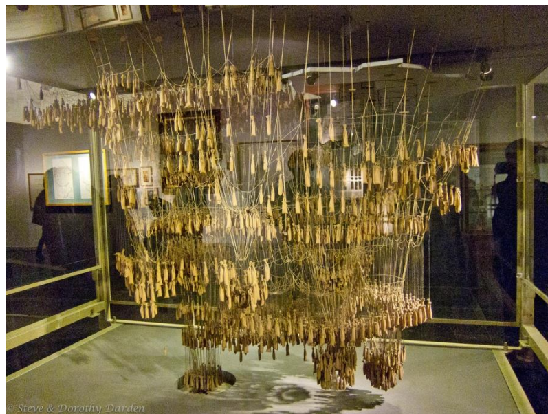
Figura 4 – Modelo de correntes suspensas por Gaudí.
