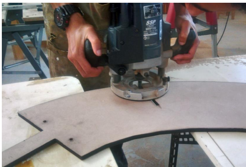
Figura 77 – Utilização da máquina de tupia.
