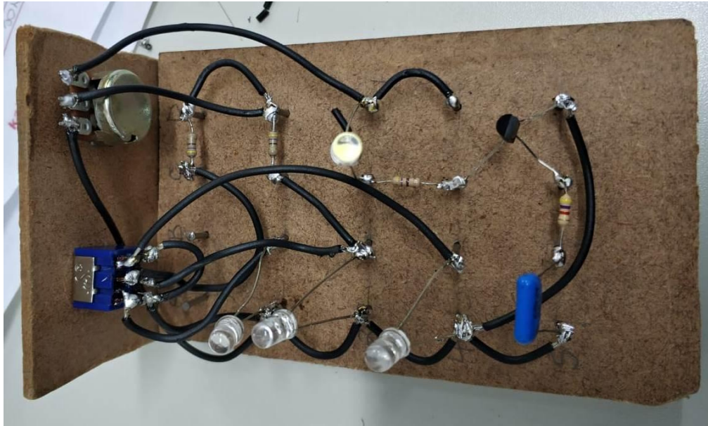
Figura A.11: Soldagem dos Condutores Necessários (Parte III)
