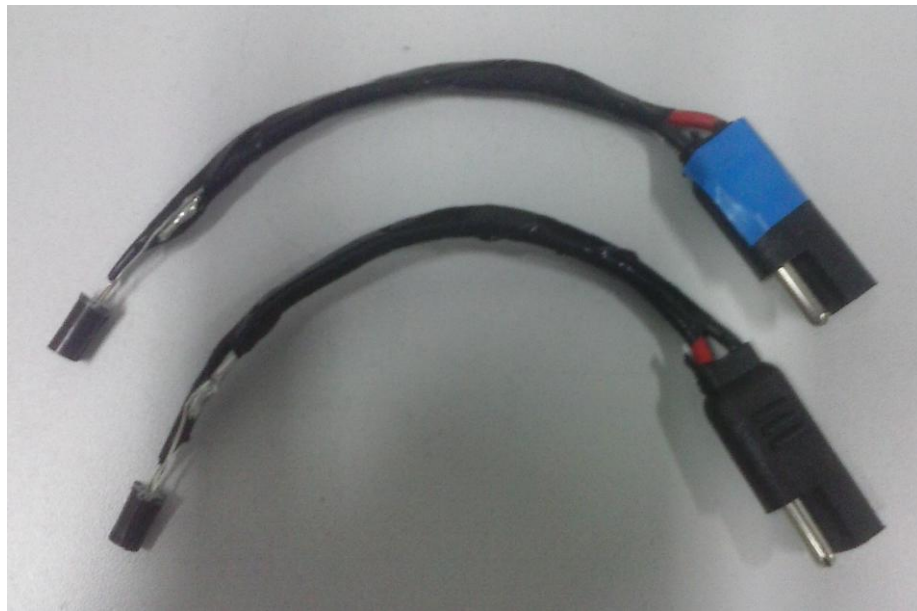
Figura A.13: Sensores de Luz Confeccionados
