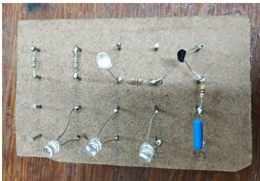
Figura A.6: Resultado da Soldagem de Componentes na Base de Montagem
