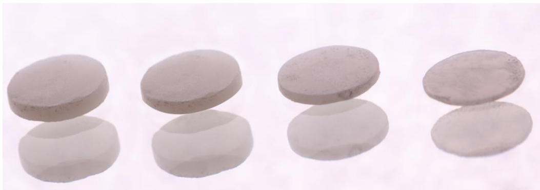
Figura 2 - Laminados cerâmicos de baixa translucidez (LT) com espessuras de 1mm; 0,7mm; 0,5mm e 0,3mm.
