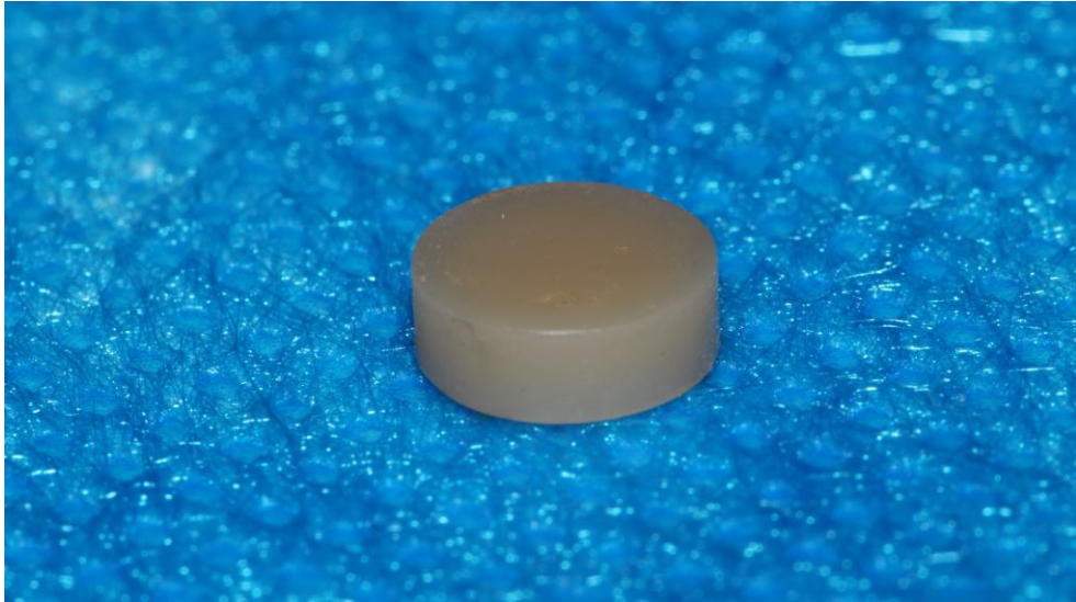
Figura 5 – Disco de resina composta confeccionado para simular uma condição de substrato escurecido.
