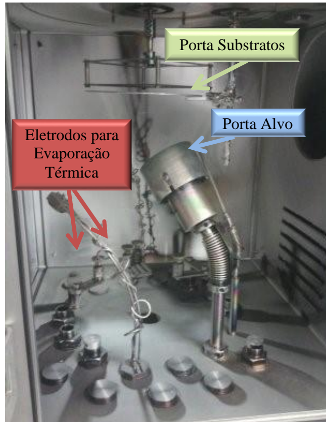
Figura 17: Vista interna da Câmara de Deposição
