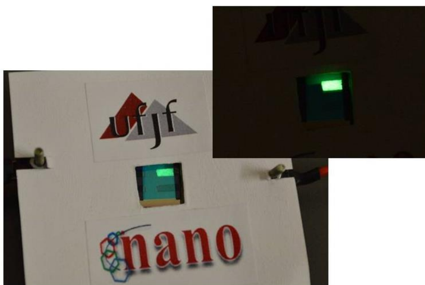
Figura 58: Fotos do OLED crescido com ITO otimizado.
