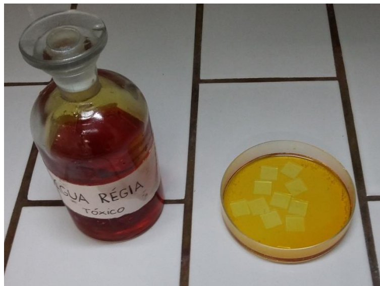
Figura 14: Limpeza de substratos utilizando Água Régia.
