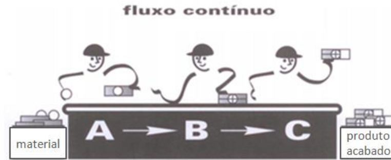
Figura 12-Produção em fluxo contínuo Fonte: Adaptado de Rother e Shook (1998)
