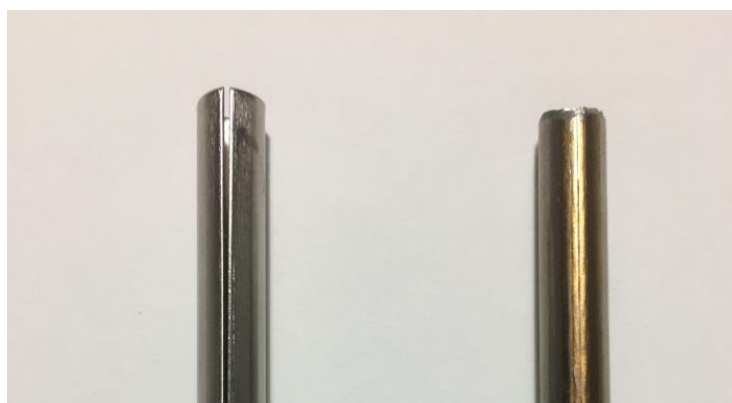
Figura 18 - Tubo sem solda e soldado
