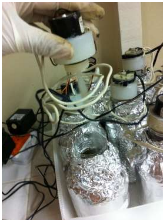
Figura 5: Foto do experimento de decaimento de carbono e atividade bacteriana a partir de amostras dos rios Negro e Solimões, destacando a espátula giratória.
