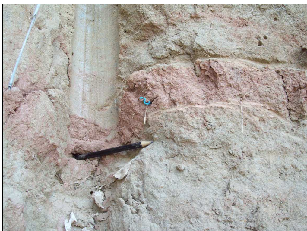
Foto 6.9. Fase argilosa (camada 2) correspondente à acreção vertical por transbordamento.
