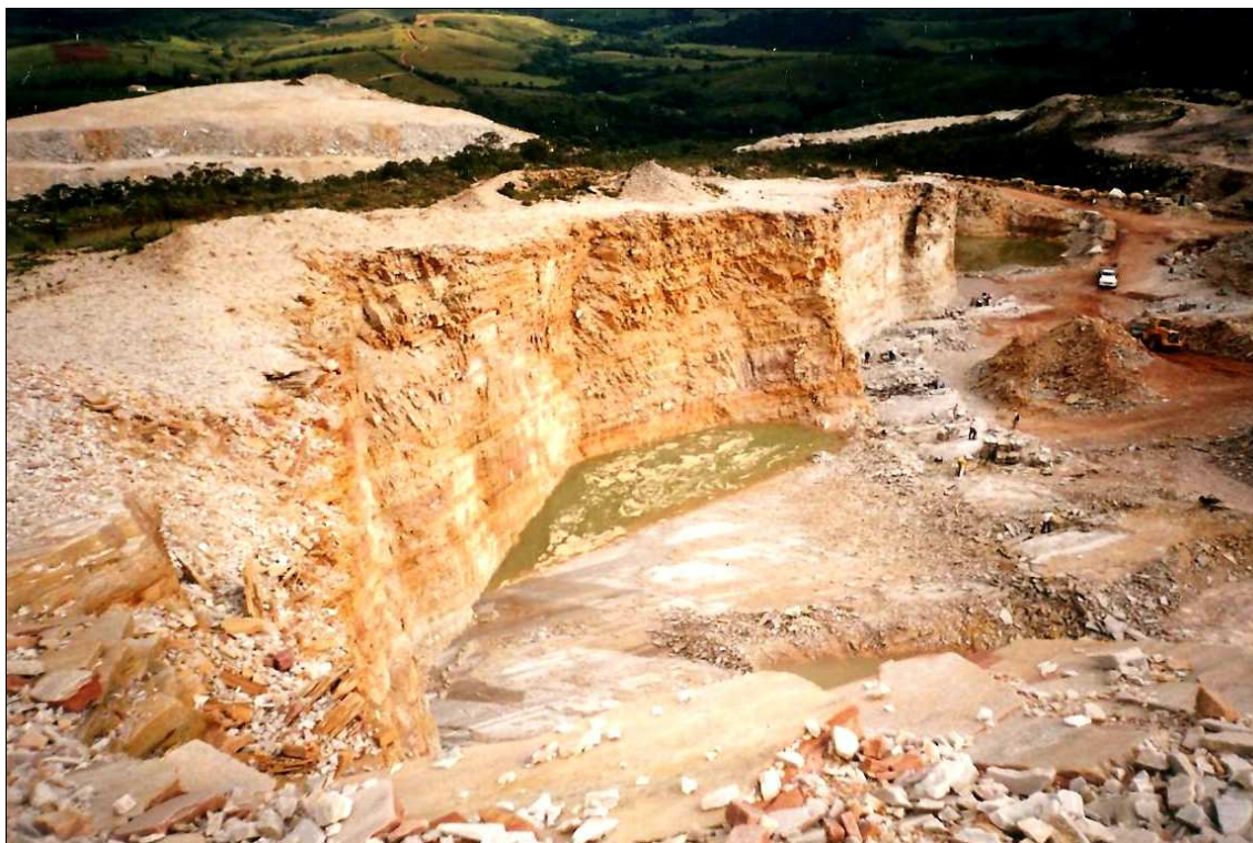
Foto 7.15. Talude em 90° aberto pela extração de quartzito a céu aberto na vertente oeste da Serra de São Tomé, em São Thomé das Letras.
