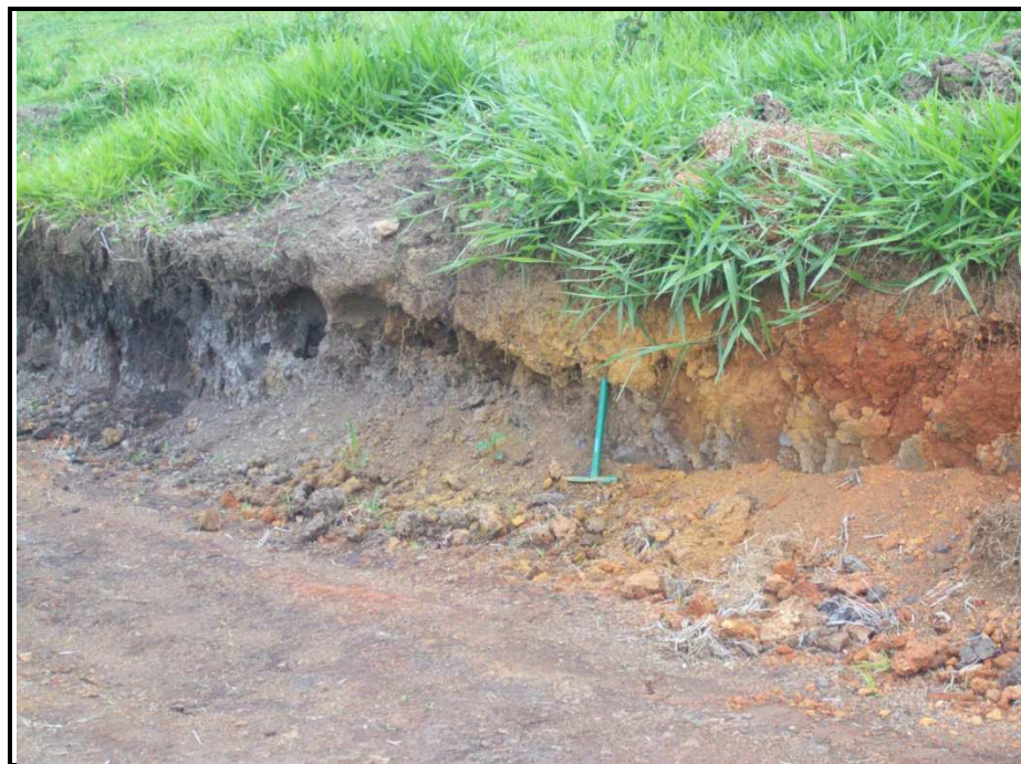
Foto 5.20. Emparelhamento dos depósitos orgânicos em questão com coberturas fundamentalmente minerais, indicando esforço tectônico ativo.
