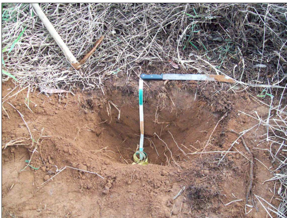
Foto 6.20. LATOSSOLO VERMELHO-AMARELO Distrófico oriundo de colúvio pedogeneizado em baixa vertente (Lambari, MG). UTM: 7574130/467873
