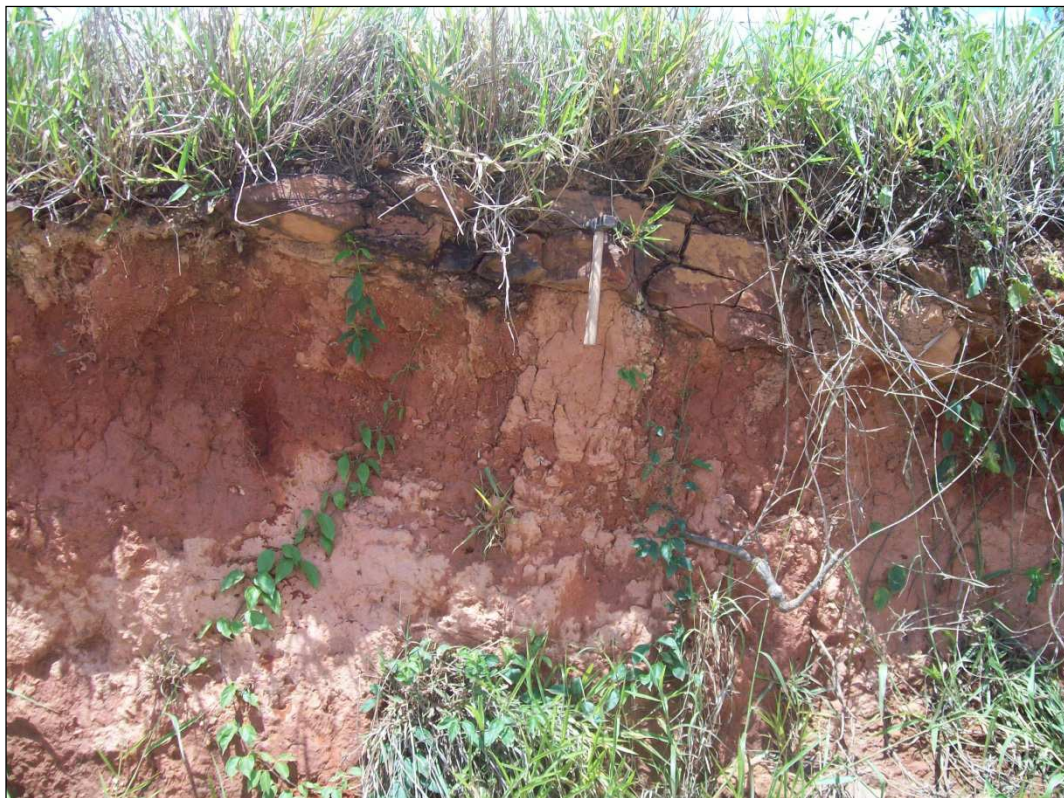
Foto 4.10. Perfil laterítico em topo aplainado (São Thomé das Letras, MG). 7600650/ 0499935. Alt. 1010 metros.
