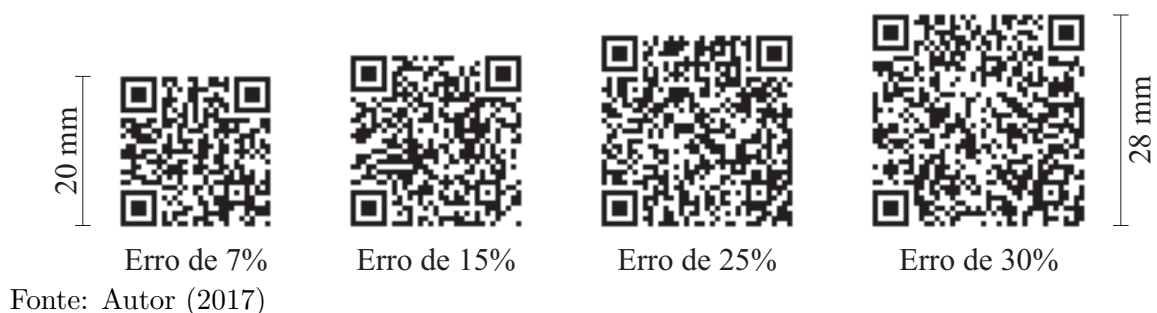
Figura 27 – Níveis de correção de erro para QR Code
