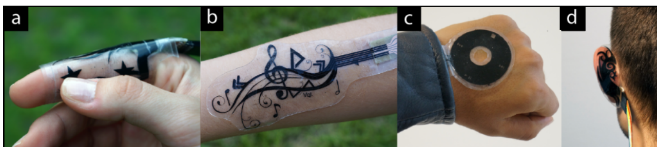
Figura 9. Projeto iSkin . Quatro interfaces de pele: (a) FingerStrap , um controlador de chamadas telefônicas, (b) uma superfície input na pele do braço para controlar música, (c) um controlador circular sobre a mão para capturar movimentos gestuais circulares e (d) um controle de fone de ouvido atrás da orelha. Fonte: Adaptada de (WEIGEL et al., 2015).
