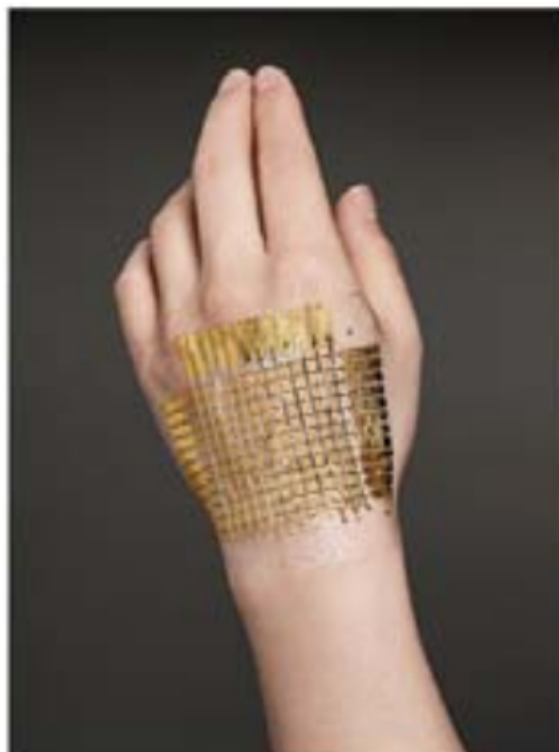
Figura 5. Transistores orgânicos ultraflexíveis que integram imperceptíveis sistemas eletrônicos orgânicos
