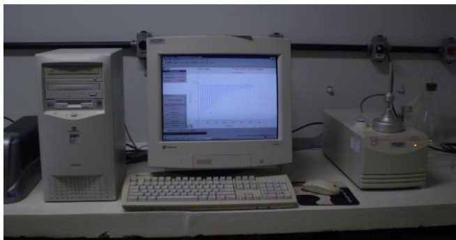
Figura 11- Calorímetro de titulação isotérmica e itens anexos.
