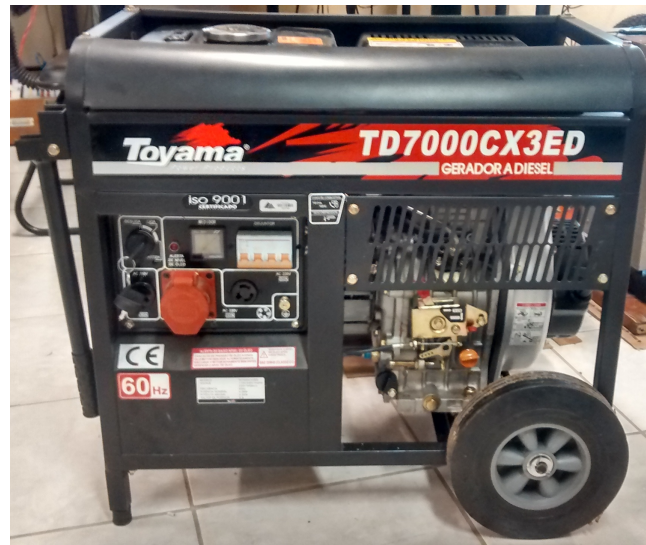
Figura 57: Fotografia do gerador à diesel de 5,5 kW modelo TD7000CX3ED, fabricado pela empresa Toyama e disponível no NAEP.
