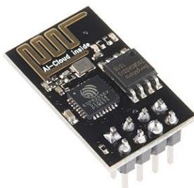
Figura 30: Módulo Wi-fi ESP8266.
