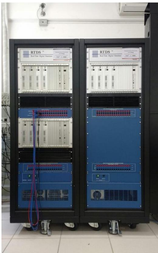
Figura 50: RTDS utilizado para as simulações.
