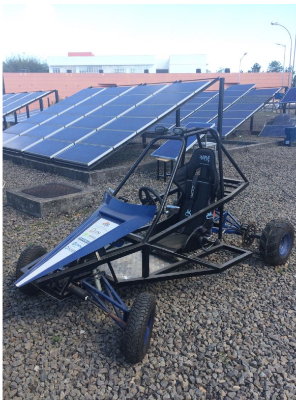
Figura 1: Fotografia do veículo elétrico de pequeno porte em desenvolvimento no Laboratório do Núcleo de Automação e Eletrônica de Potência e Laboratório Solar da UFJF.
