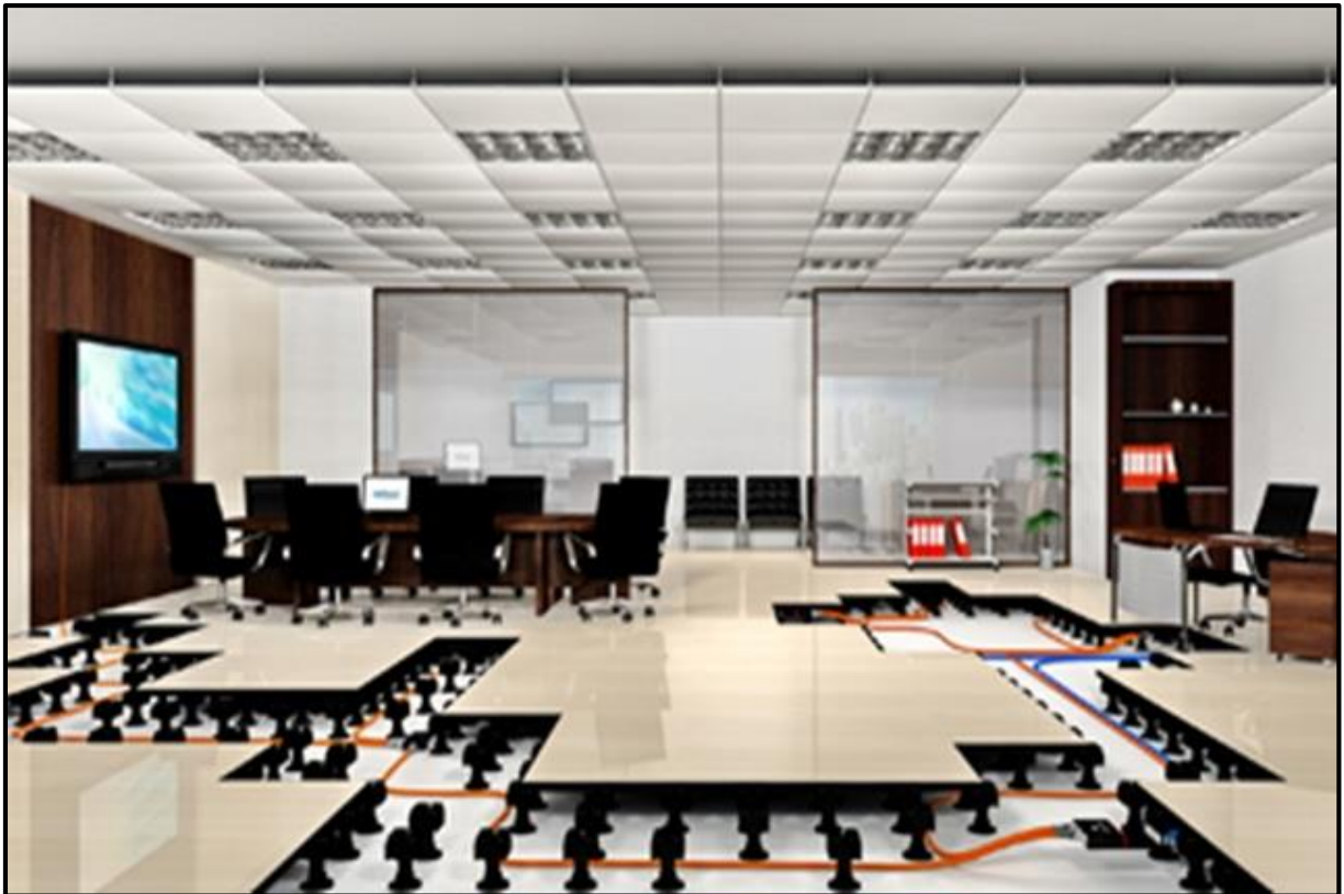
Figura 42 - Exemplo de Instalação Feita em Piso Elevado
