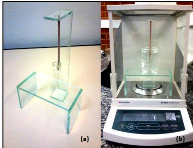
Figura 7.2 - (a) Suporte de vidro e (b) aparato montado sob a balança analítica para a determinação da massa aparente das amostras.
