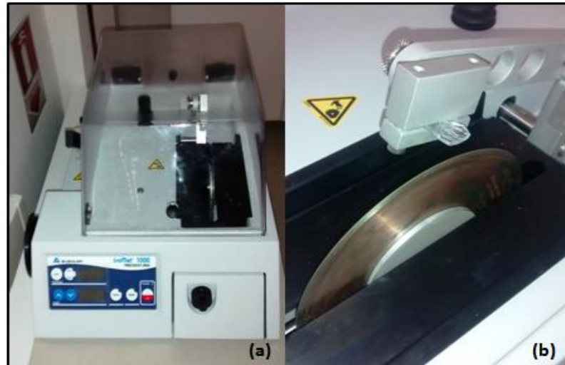
Figura 6.6 - (a) Equipamento usado para cortar as amostras e (b) amostra sendo cortada pelo disco do equipamento.
