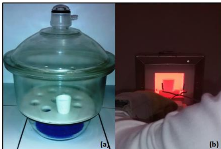
Figura 6.3 - (a) Dissecador para evitar retenção de umidade na mistura-amostra e (b) forno em funcionamento, aberto após a completa fusão da mistura.
