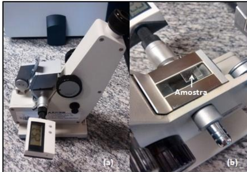
Figura 7.4 - Refratômetro utilizado para a determinação do Índice de Refração Linear (IRL) das amostras: (a) parte exterior e (b) parte interior onde a amostra é acoplada ao prisma refrator.
