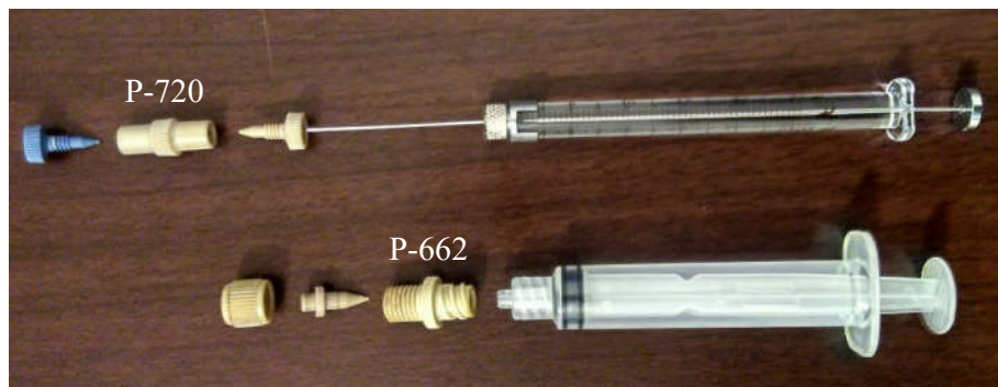
Figura 11 – Fotografia mostrando seringas e conexões utilizadas no preparo das colunas monolíticas
