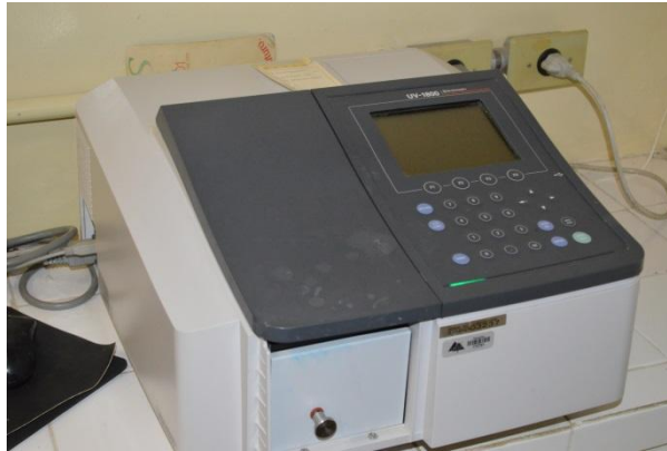
Figura 36: Aparelho para medir a Absorção UV-vis dos compostos orgânicos. Fonte: Fotografado pelo autor (2015).
