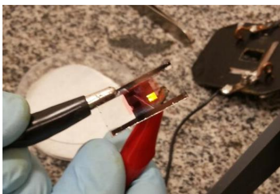
Figura 69: Dispositivo feito com o líquido iônico PHF057 e usando PEDOT-PSS. Fonte: Fotografado pelo autor (2015).
