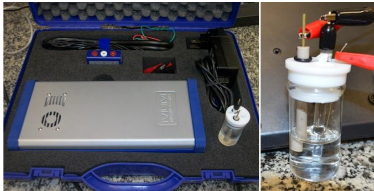
Figura 32: Aparelho usado para a Voltametria Cíclica e dos eletrodos na solução de KCl. Fonte: Fotografado pelo autor (2015).
