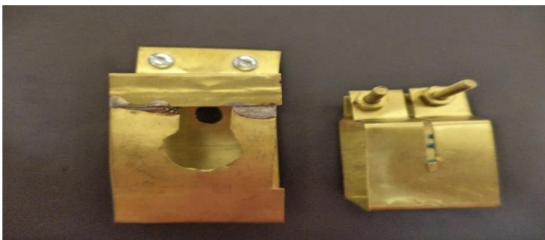
Figura 25 - Encaixes de segurança para seringa e êmbolo construído em parceria com o departamento de física da UFJF
