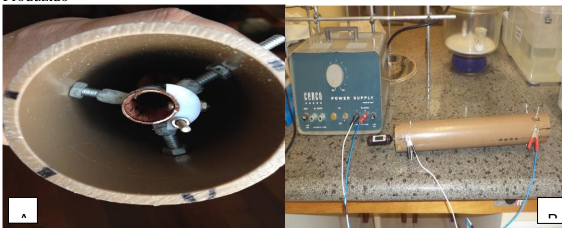
Figura 31 -A -construção do Mini-forno para aquecimento da FEM B –Mini-forno Produzido
