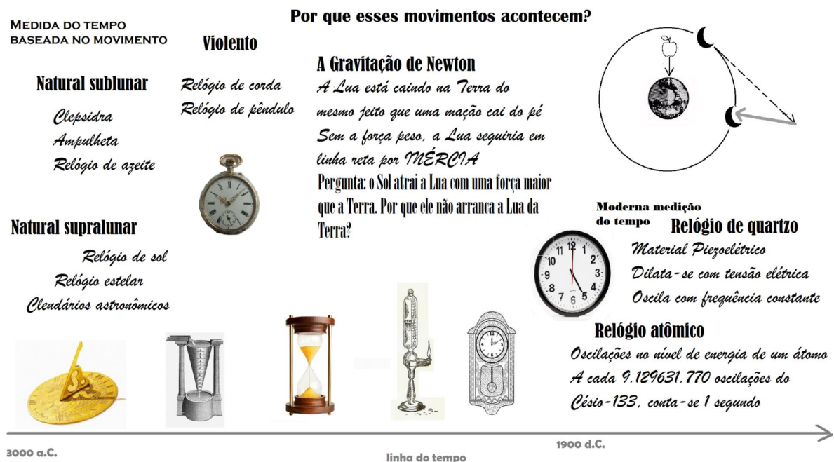
Figura 3.11: Tipos de relógio segundo seu princípio de funcionamento. Fonte: Elaborado pela autora.
